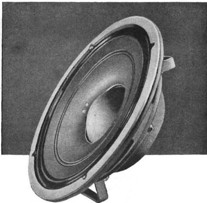
Fig. 3.13. - Altoparlante a cono-membrana, nel quale sono utilizzati i principi dell'altoparlante a cono e dell'altoparlante a tromba, ossia a diffusore diretto ed a compressione. Il cono sostituisce la tromba nella diffusione delle frequenze elevate. Diametro cono 28 centimetri, potenza continua 30 watt (Western Electric). 1
