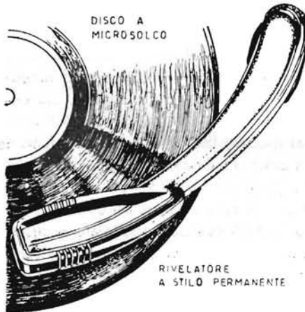
Fig. 6.13. - Braccio curvato e festina spostata per limitare l'errore di tangenzialità.
