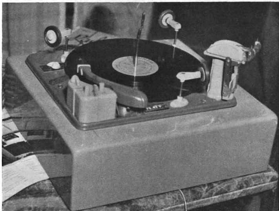
Fig. 6.50 - Cambiadischi automatico del tipo «a due facce». Suona prima un lato e poi l'altro di ciascun disco. I dischi scendono prima sulle tre rotelle gommate, e lo stilo del pickup si appoggia sotto di essi; scendono quindi sul piatto (Produzione Markel, testina a cristallo Astatic, importazione Imcaradio).
