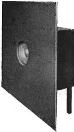
Fig. 5.15. - Altoparlante in cassa completamente chiusa, con schermo frontale.
