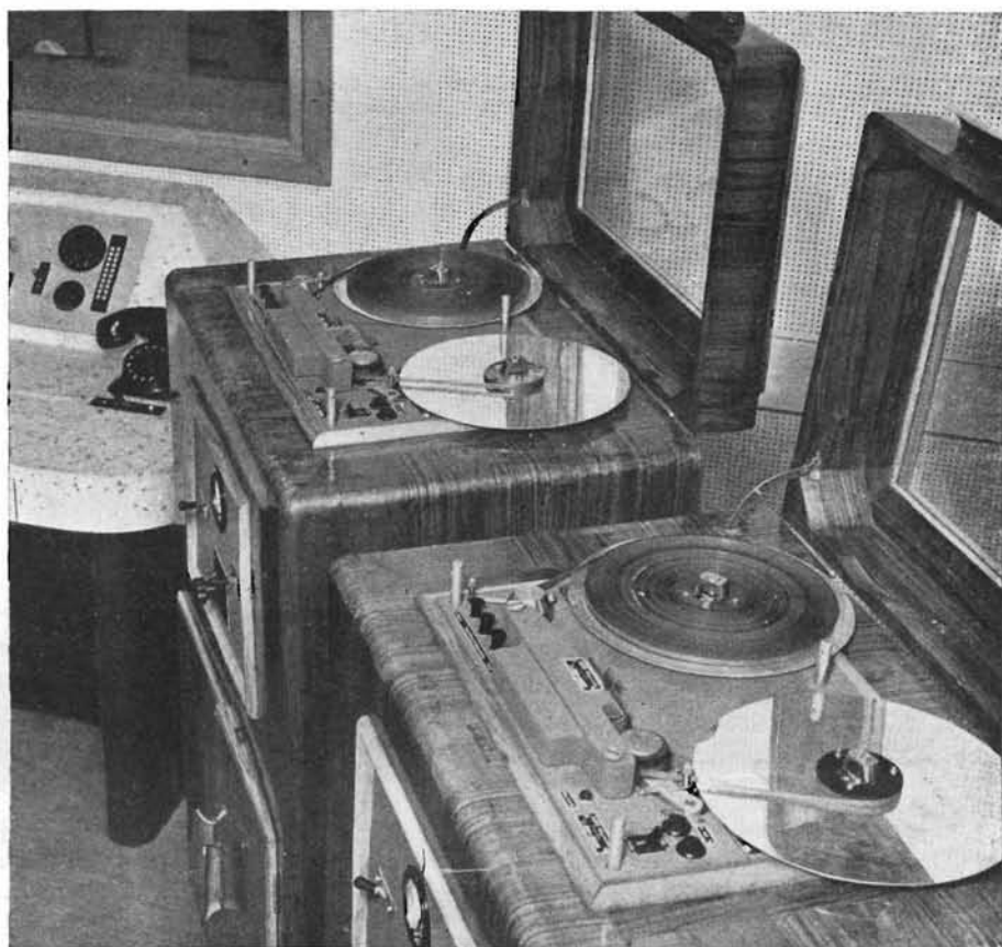
Fig. 12.23. - Registratori magnetici a nastro usati dalla Radio Italiana per le registrazioni da studio. Velocità del nastro: 38,1 cm/sec, oppure 76,2 cm/sec. Gamma acustica da 50 a 10.000 sino a 15.000 c/s, più o meno un decibel. Dinamica di registrazione di 50 dB. Questi apparecchi superano in perfezione qualsiasi altro sistema di registrazione attualmente esistente, compreso il film sonoro. I radioascoltatori non hanno la possibilità di distinguere tra un programma musicale diretto ed uno registrato, al contrario di quanto avviene per i dischi. A seconda delle dimensioni, le bobine consentono registrazioni da 20 a 35 minuti, senza interruzione.
