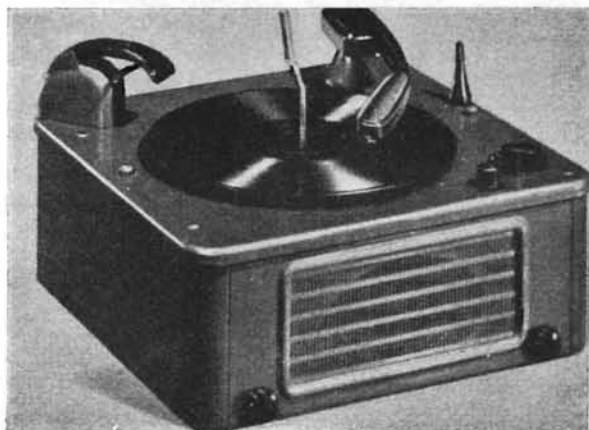
Fig. 6.42. - Cambiadischi automatico con amplificatore e altoparlante.
